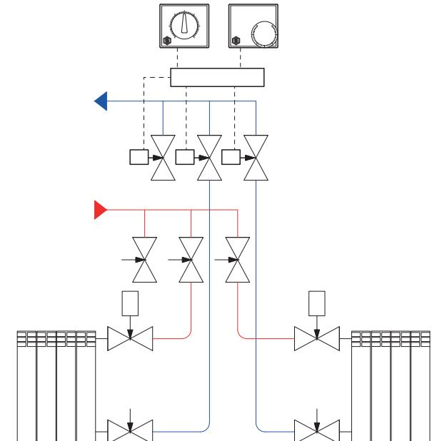
Система радиаторной разводки с коллекторной группой SMS 0922 и PE-Xb/AI/PE-Xb трубами
