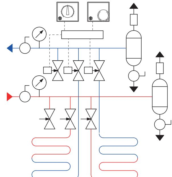
Система теплого пола с коллекторной группой SMS 0907 и PE-Xb/AI/PE-Xb трубами
