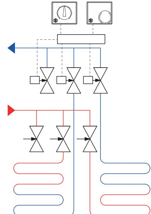
Система теплого пола с коллекторной группой SMS 0917 и PE-X трубами
