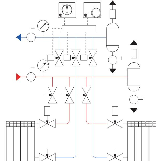
Система радиаторной разводки с коллекторной группой SMS 0912 и PE-Xb/AI/PE-Xb трубами
