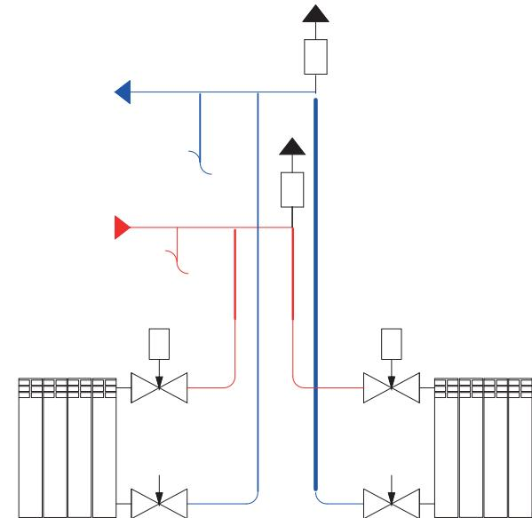
Система радиаторной разводки с коллекторной группой SMS 0923 и PE-X трубами
