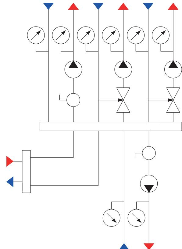
Гидромодули быстрого монтажа с вертикальным гидравлическим разделителем, коллектором распределительным универсальным и водогазопроводными трубами
