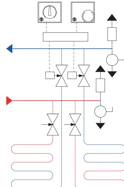
Система теплого пола с коллекторной группой SMS 0927 и PE-X трубами
