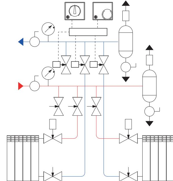
Система радиаторной разводки с коллекторной группой SMS 0912 и РЕ-Х трубами
