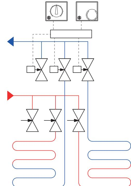
Система теплого пола с коллекторной группой SMS 0917 и PE-Xb/AI/PE-Xb трубами
