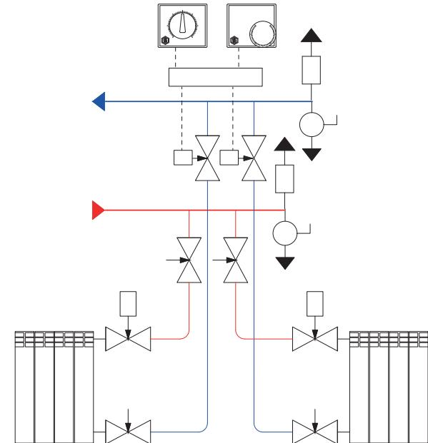
Система радиаторной разводки с коллекторной группой SMS 0932 и PE-Xb/AI/PE-Xb трубами
