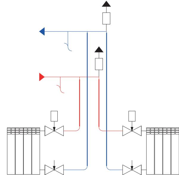
Система радиаторной разводки с коллекторной группой SMS 0923 и PE-Xb/AI/PE-Xb трубами
